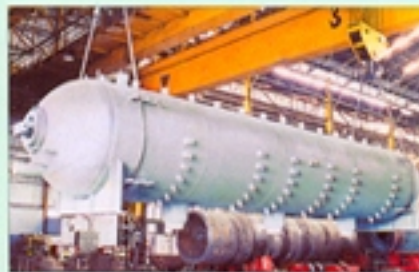
El diseño muestra uno de los tambores de alta presión, con espesura de 160 mm, con peso 120 MT y sellado 'S' por ASME, suministrado a "Foster Wheeler Energy Corporation", EEUU para uso en "Florida Power & Light Co.", EEUU
